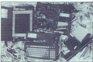
Slika 3. Vsi deli hkrati: akumulatorji, disk in disketnik, ohišje s tiskalniki, vzeti, tipkovnica in razstavljeni zaslon.
