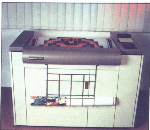
Versatec 8900: elektrostatični tiskalnik 3. generacije
