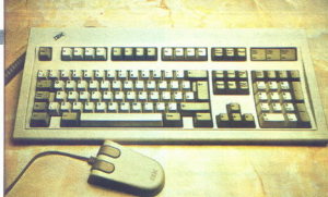
Nova tipkovnica s 102 tipkami je izboljšava standarda A/T/E. Numerične in kursorne tipke so zdaj ločene, novi evanĝelji bo poslej očitno dvanajstetera funkcijskih tipk. Tudi elegantna miška je standarden del.
