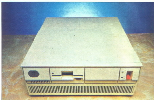
Za nove stroje IBM je značilno, da niso več tako »zujetni« kot prejšnji PC. To velja tudi za novi 3,5-palčni diskovni pogon, ki se mu obeta, da bo obstal. Glavno snikalo se je preselilo na sprednji del, ključavnica pa je zdaj zadaj.
