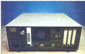
Vsa standardna vrata vodijo od matične plošče in reže so zdaj zato proste za nadalje razširitev. Z leve proti desni: priključki za tipkovnico, miš, dvosmerni Centronics, RS 232C in video izhod. Ventilator, vdelan v sredini, je skoraj neslišen.
