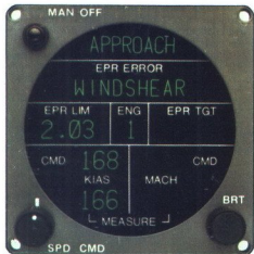
Instrument Sperryjevega računalnika, s katerim je mogoče odkrivati in meriti navzdolne sunke vetra.
