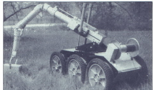
Francosko obrambno ministvo je poleg drugih avtonomnih vozil naročilo robota za odkrivanje min. Robot je teledirigiran, opremljen s šestimi kolesi in gosonicami (vzpenja se lahko celo po stopnicah), gibljiva roka pa ima 7 ločnih stopinj manevrskega prostora.
