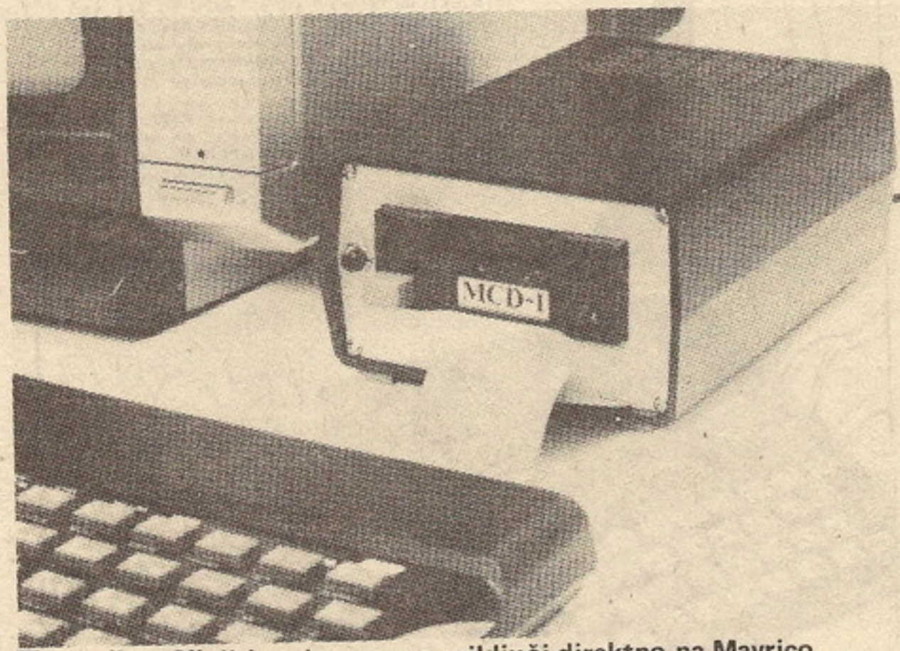
Thurnall-ov 3" disketni pogon se priključi direktno na Mavrico
