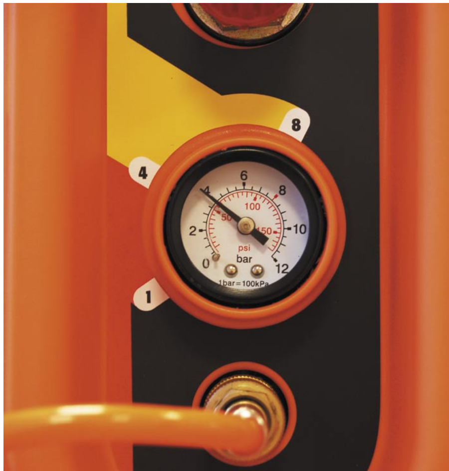
Za izpihovanje prahu iz računalnika nastavimo kompresijo na 4 bare (400 kPa).
