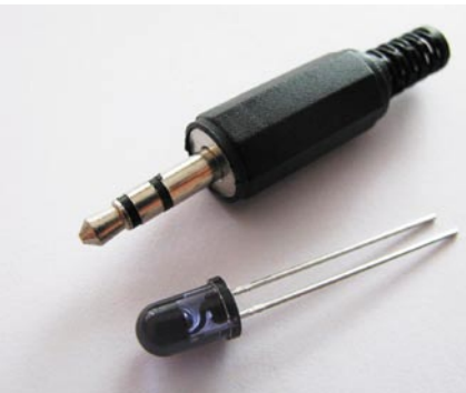
3,5 mm vtikač in IR-dioda sta najpomembnejši komponenti.
