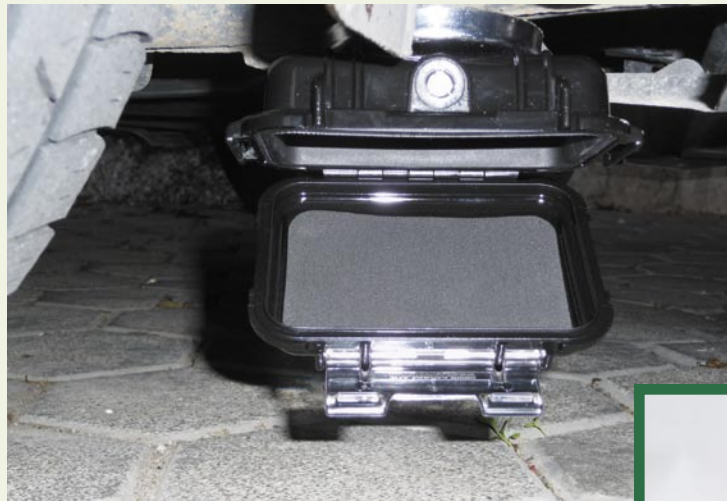
Namestitev sledilne naprave v posebno ohišje z močnim magnetom na karoserijo avtomobila.
