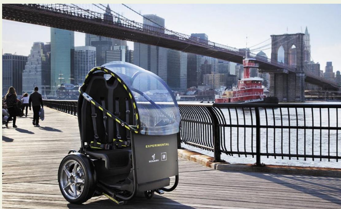
▲ Novo mestno vozilo poganja elektrika, dolgo je le dober meter, v njem lahko sedita dva, ki ga načeloma lahko celo dvigneta, saj ni težje od 150 kg.
