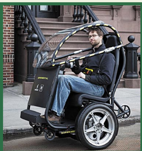
▲ Prototipno vozilo nazorno kaže ojačitve potniške kabine, ki naj bi zagotovile ustrezno raven varnosti. ■
