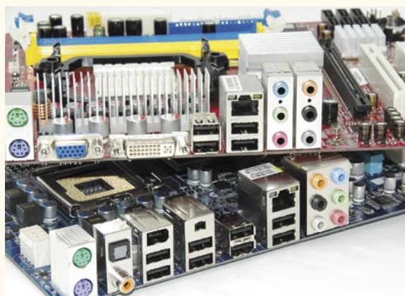
Danes imajo vse matične plošče vdelane en, nekatere celo dva omrežna priključka.
