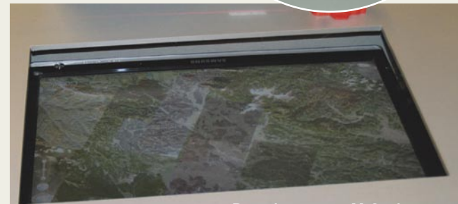
Prototip naprave MtOuch, občutljiva na več dotikov. Tisto rdeče je prikaz izvora laserske svetlobe. Dva sta vgrajena v napravo.
