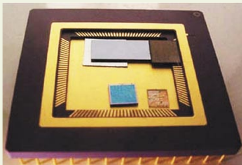
Samopogonski senzor svetlobe za optične komunikacije: Atomski mikrogenerator (na sliki: dva siva pravokotnika) poganjata enostaven procesor (modri pravokotnik) in fotodiodo (manjši svetlorjavi pravokotnik)
