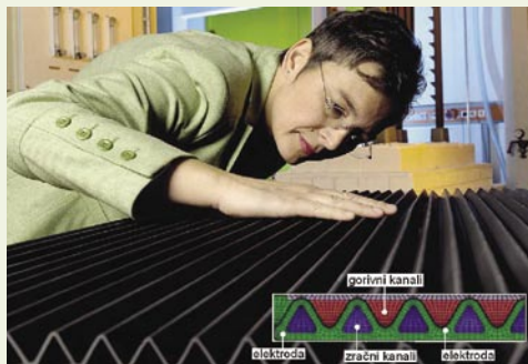
Na poti do okolju prijazne energije: Raziskovalka pregleduje nove valovite gorivne celice za bodočo elektrarno.
