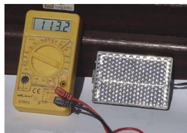
Celica ima deklariran kratostični tok 80 mA.
