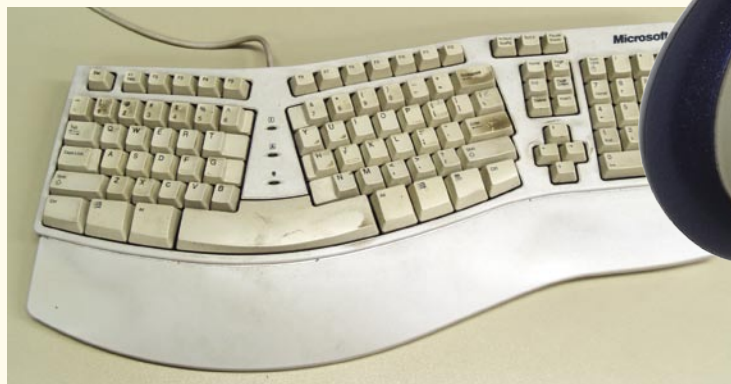
Če boste odstranili tipke, tipkovnico najprej fotografirajte, da boste potem znali tipke vrniti na pravo mesto.
