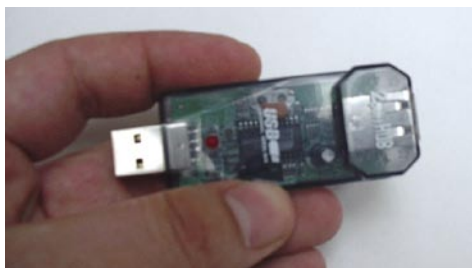
Z USB-zvezdiščem lahko podaljšamo domet kamere.
