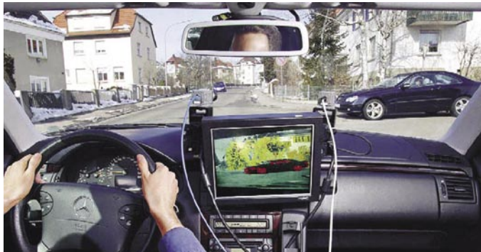
Pomočnik za križišča: Poskusni sistem podjetja DaimlerChrysler s kamerami, ki pregledujejo okolje, v primeru nevarnosti reagira v milisekundah.
