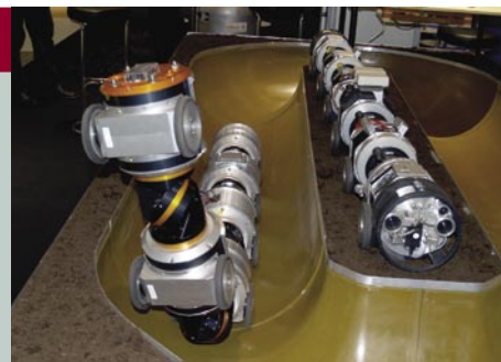
Modularni robot, namenjen preverjanju kanalizacij in podobne infrastrukture.
