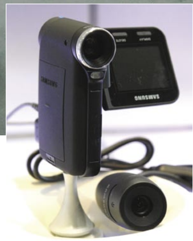
Kamera z dvojno optiko, eno na krajšem kablu, ki jo lahko namestimo na čelado, na primer pri smučanju.
