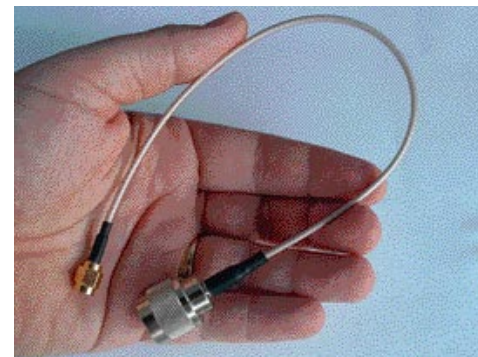
Pigtail - prehod iz SMA na N - možnost prehoda na manj izgubni kabel
