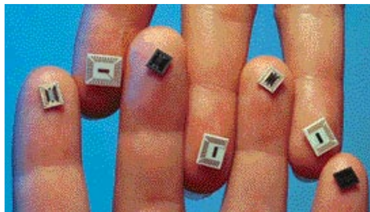
Nadzor in upravljanje stavb: Mikroelektromehanski sistemi (MEMS) lahko merijo temperaturo, osvetlitev in druge parametre ter med sabo inteligentno komunicirajo.
