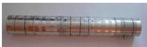
Usmerjena antena - osnova so konzerve
