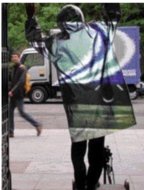
RPT v praksi: tovornjak izza človeka vidimo zaradi projekcije slike iz kamere, usmerjene proti ozadju (vidna je blizu nog).
