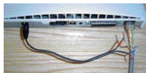
Končni izdelek na drugi strani UTP-kabla. Pred uporabo ne pozabite izolirati vodnikov za prenos električne napetosti, da ne pride do kratkega stika.
