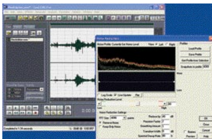
Sound Forge 8 velja za »Photoshop zvoka« in med drugim omogoča popraviljanje zvoka z vinilne plošče ali magnetnega traku v enem koraku.
