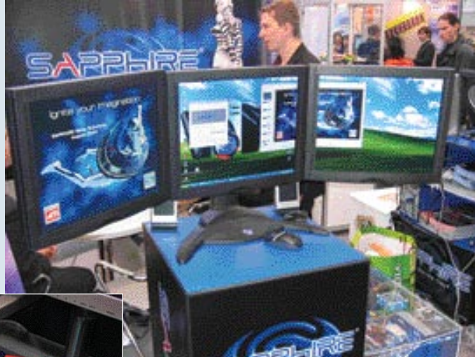
Krmiljenje do štirih zaslonov dosežemo s kombinacijo v matično ploščo vdelane grafike ter dodatne grafične kartice (ali pa se gremo SLI z Nvidio)
