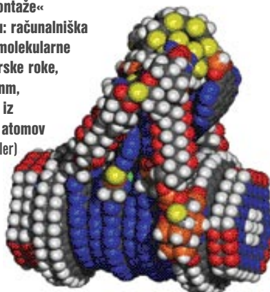
Diferencialni mehanizem za nanostroje: »škafli« z vrsto zobnikov, sestavljenih iz nekaj tisoč atomov, za kompenzacijo spremembe kota gibanja
