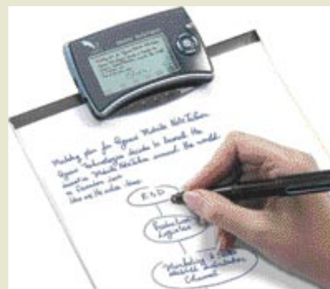
Pegasusov optični senzor, ki digitalizira in hrani pisanje in risanje po papirju.
