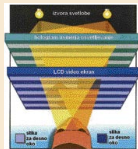
Ozadnja svetloba osvetljuje zmeraj novo sliko, s katero je »moduliran« hologram in ki prihaja na video zaslon nekoliko različno za dve očesi, kar omogoča uporabniku pridobivanje prostorske slike.
