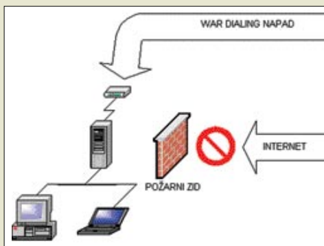
Prikazuje način obitja požarnega zidu (backdoor) prek modema in programa za oddaljeni dostop.
