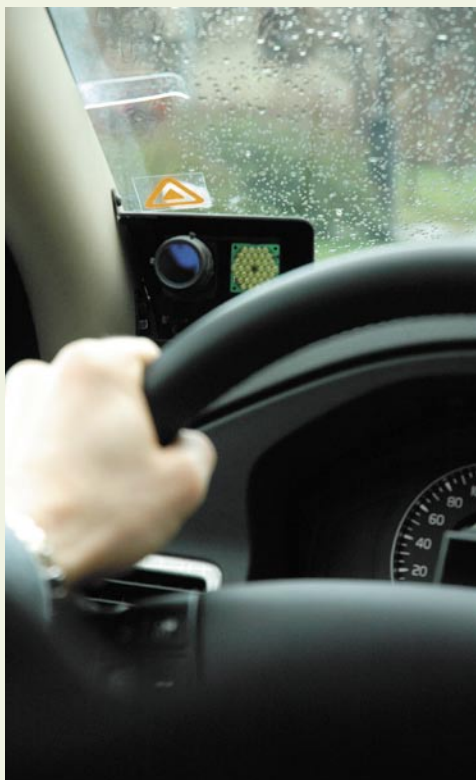
Kamere, usmerjene v voznika, so namenjene preučevanju premika njegove glave in oči.
