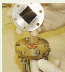
Baterija za vse čase: BetaBattery proizvaja energijo z razpadom radioaktivnega izotopa, in ne s kemijskimi reakcijami.
