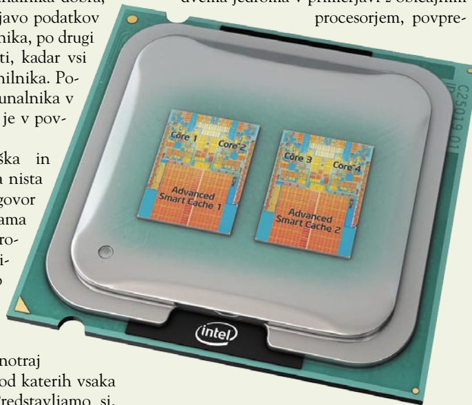
Štirijedrni procesor Penryn, oziroma natančneje: 2 dvojedra procesorja v enem čipu
