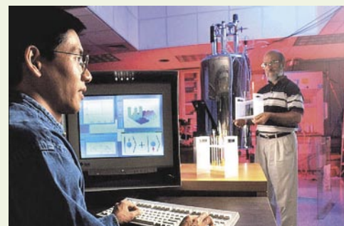
Prva uporaba kvantnega računalnika: Dr. Isaac Chuang iz IBM-a in Constantino Yannoni iz MIT-a sta za kvantno izračunavanje uporabila interakcije spinov jedra znotraj posebej oblikovane molekule.
