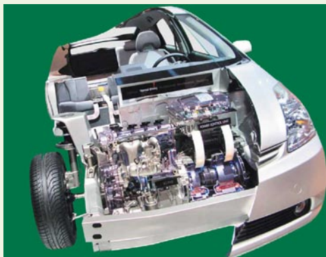
Povsem nov dizajn: Toyota je za integriranje hibridnega motorja, elektromotorja, kompleksne elektronike, prenosa in akumulatorjev v modelu Prius vpeljala novo oblikovanje.
