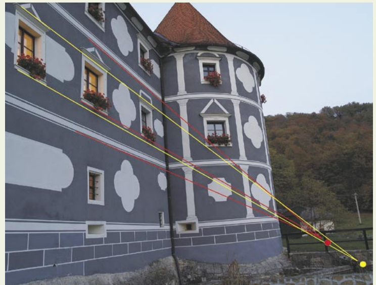
Dodali smo eno okno. Točka izginotja ni ista za vse vzporedne linije.
