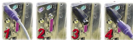
Aktiviranje naprave KeeLogger PS/2 v treh preprostih korakih: odklop tipkovnice, priključitev KeeLoggerja in ponovna priključitev tipkovnice.
