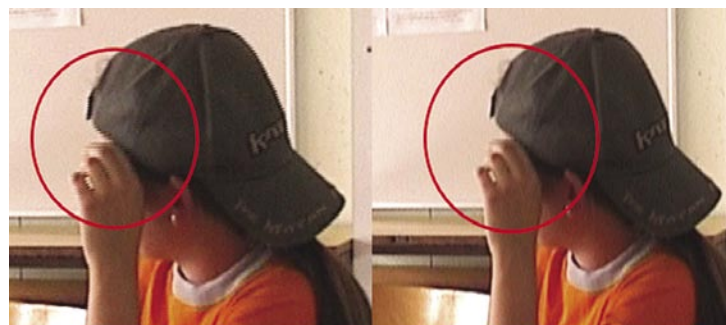
Razlika med prepleteno (levo) in neprepleteno sliko (desno)
