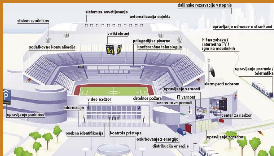
Pod žarometi sveta: Shema dvorane Allianz Arena v Münchnu, v kateri so nameščene številne tehnologije podjetja Siemens, od sistema osvetljevanja prek nadzora dostopa do varnostnega sistema.
