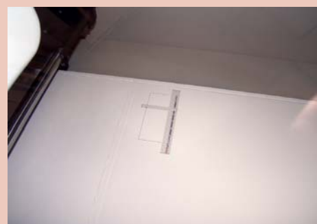
Izdelava plasti. Ko se vodilo giblje iz desne proti leve, nanese plast prahu, v obratni smeri pa glave »brizgajo« lepilo in barve.
