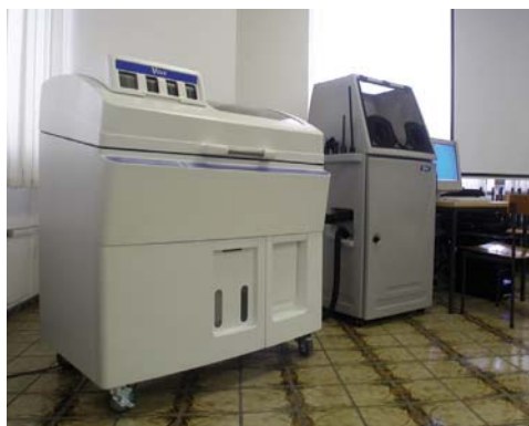
Naprava skupaj s komoro, ki je vračunana v ceno in kjer očistimo izdelek po izdelavi.
