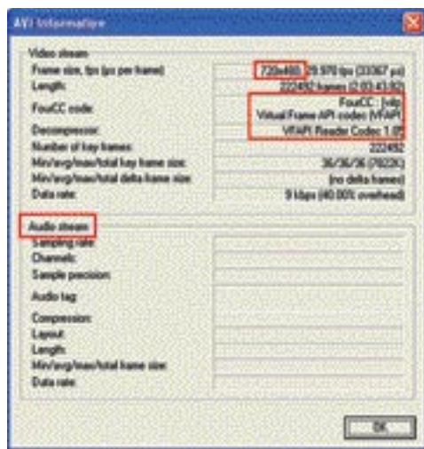
Ugotavljanje velikosti slike v VirtualDub Modu. Zvoka še ni, film pa je narejen s pretvornikom VFAP.
