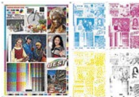
Tiskalniki tiskajo v načinu CMYK, levo barvni izpis, desno razdeljen na kanale.
